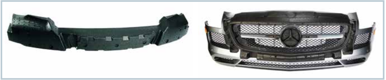
Bild 1. Stoßfängerkerne einst (links) und heute (rechts) sind typische Anwendungen für Partikelschäume im Nicht-Sichtbereich. Sie schützen beim Aufprall mit geringer Geschwindigkeit den Frontbereich des Wagens und dienen dem passiven Fußgängerschutz (Bilder: Ruch Novaplast)
