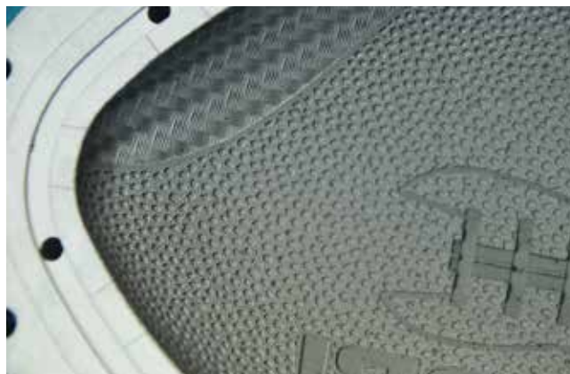
Bild 6. Die Lasertexturierung eröffnet einen nahezu unendlichen Gestaltungsspielraum, um die Oberfläche von Partikelschaumteilen zu veredeln
